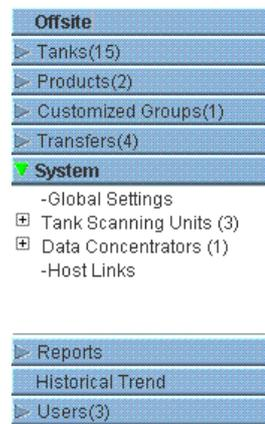
2. La figura anterior muestra el <Tankvision Subsystem> (Subsistema Tankvision), a saber, Unidades de escaneo de depósito (NXA820), Concentradores de Datos (NXA821) y Host Links (NXA822). Las Unidades de escaneo de depósito, los Concentradores de Datos y los Host Links comprenden todas las unidades NXA820, NXA821 y NXA822 respectivamente en esa red de dominio.
