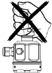
Das Ende mit dem Sensor muss nach oben zeigen. Druck auf den Sensor kann zu einer Beschädigung führen.
