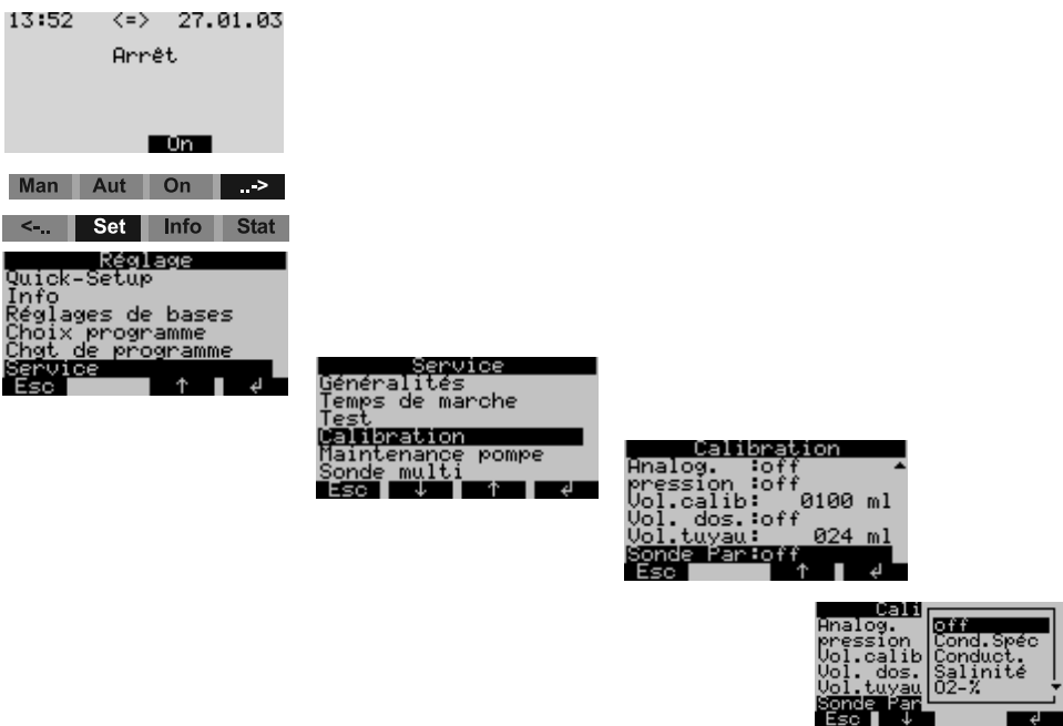
Fig. 25: Etalonnage de la sonde multiparamètre
