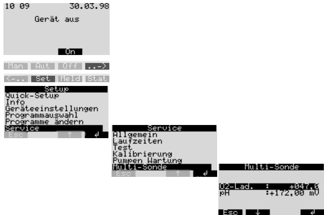
Abb. 33: Kontrolle der Sauerstoffmessung (Sensor-Check-System)
