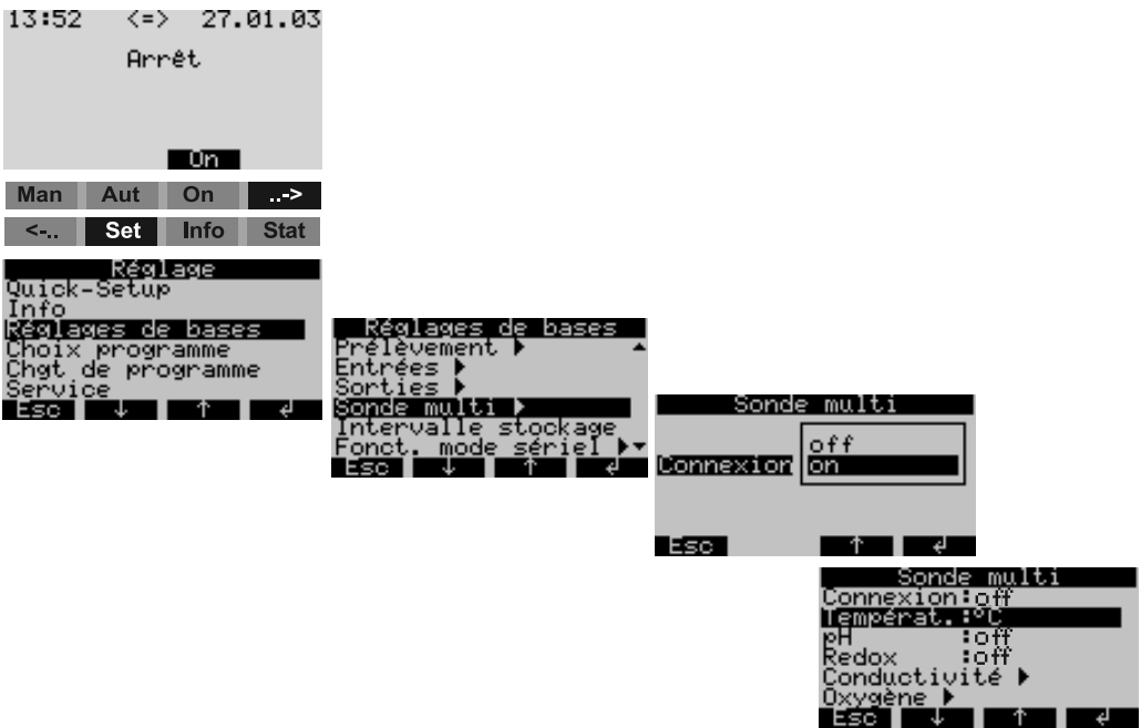
Fig. 34: Mise en service de la sonde multiparamètre (en option)
