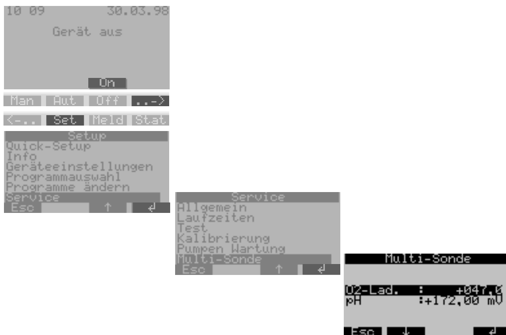
Abb. 29: Kontrolle der pH-Messung (Sensor-Check-System)
