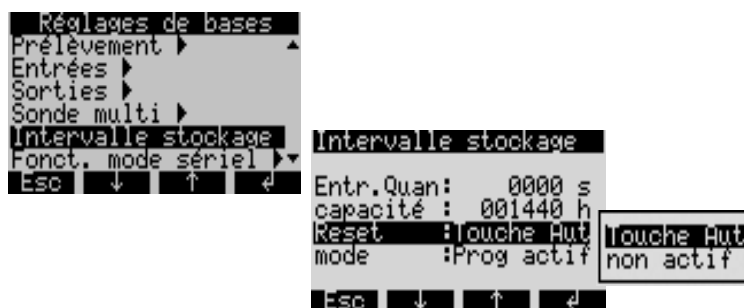
Fig. 40: Structure du menu datalogger
