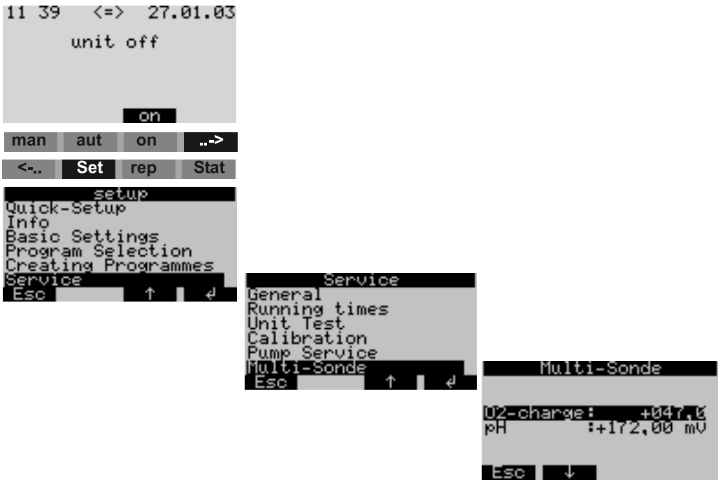
Fig. 33: Controllo della misura di ossigeno (sistema di controllo del sensore)
