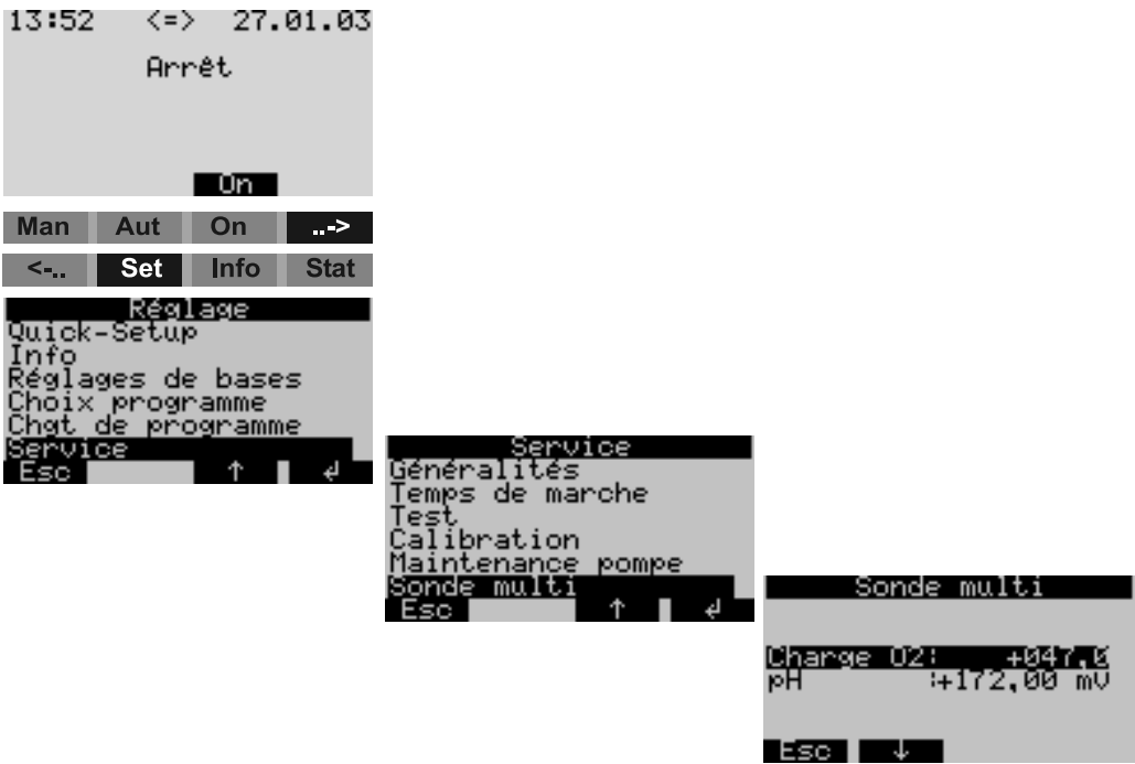
Fig. 33: Contrôle de la mesure d'oxygène (Sensor Check System)
