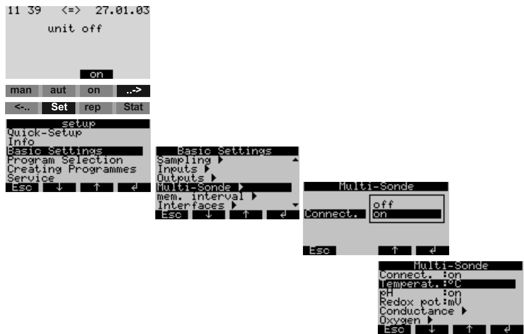
Fig. 34: Messa in servizio della sonda multiparametrica (in opzione)
