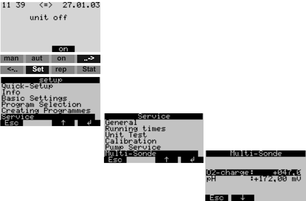
Fig. 29: Controllo della misura di pH (sistema di controllo del sensore)
