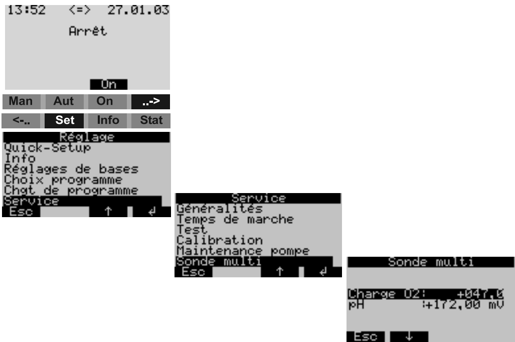
Fig. 29: Contrôle de la mesure de pH (Sensor Check System)
