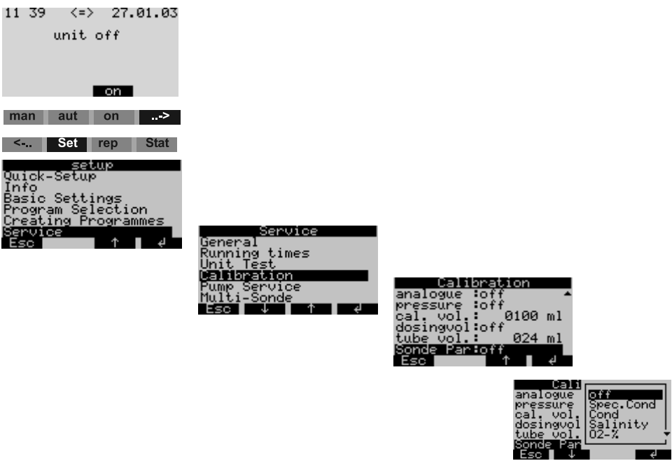
Fig. 25: Taratura della sonda multiparametrica
