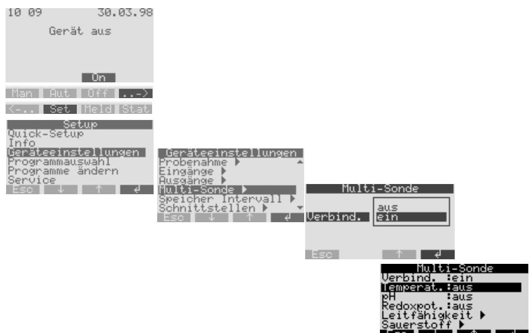
Abb. 34: Inbetriebnahme der Multiparametersonde (optional)
