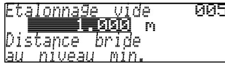
Cette fonction permet d'entrer la distance entre la bride (point de référence de la mesure) et le niveau minimal (=point zéro).
