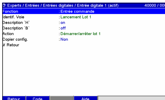
Fig. 5: Configuration - Entrées - Entrées digitales - Entrée digitale x
