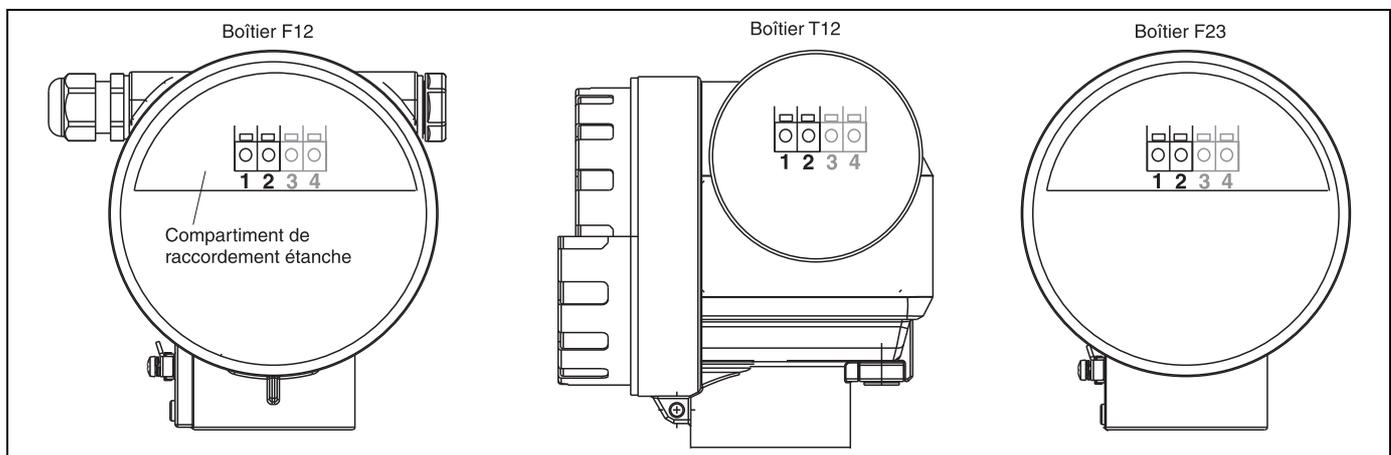
Les caractéristiques de l'appareil sont indiquées sur la plaque signalétique avec les informations essentielles concernant la sortie analogique et la tension électrique. Rotation du boîtier en rapport avec le câblage, → 25.
