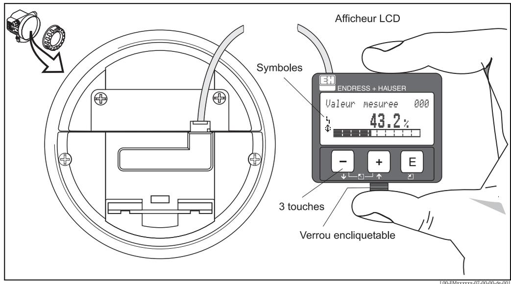
Disposition des éléments d'affichage et de configuration
