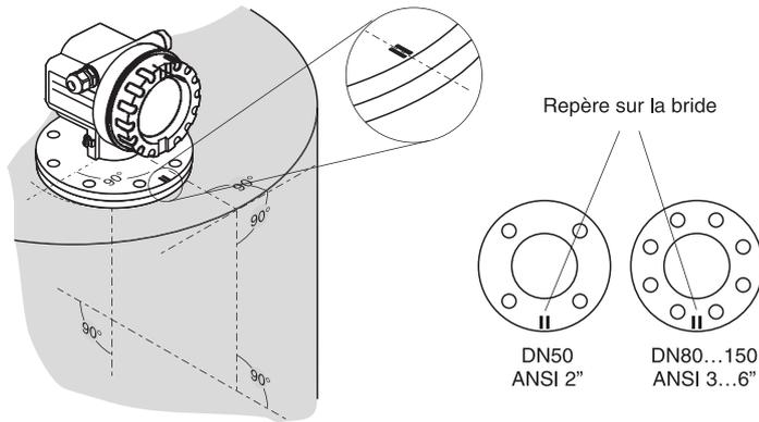
**Montage dans un tube de mesure :**
