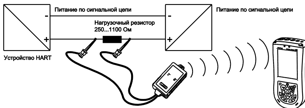
Рис. 5-1: Подключение через нагрузочный резистор
