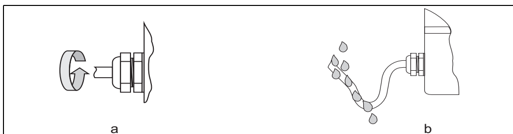
図 18: 電線管接続口の取付け
