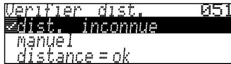
Cette fonction permet d'activer la suppression des échos parasites. Il faut comparer la distance mesurée avec la distance effective jusqu'à la surface du produit. Les différentes possibilités sont :
