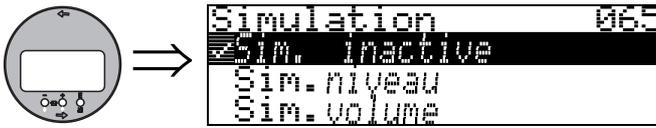
La fonction de simulation permet de tester le cas échéant la linéarisation, le signal de sortie et la sortie courant. Les différentes options de simulation sont :
