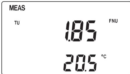
Bild 5.1 Das Display nach dem Einschalten und abgeschlossenem Selbsttest
