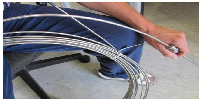
Bitte den Messeinsatz nicht am Boden ausrichten (siehe Bild links) oder spiralförmig von der Rolle ziehen (siehe Bild rechts), da dieser anschliessend nicht mehr in das Schutzrohr eingeschoben werden kann.
