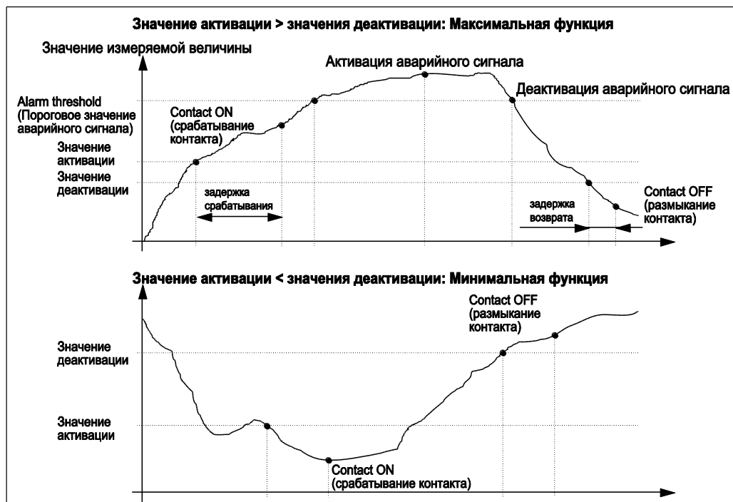
Рис 45: Схема взаимосвязи значений активации и деактивации и времени задержки срабатывания и возврата реле
