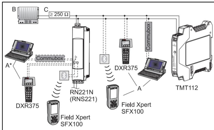
A = Anschluss HART® -Kommunikation direkt am Temperaturtransmitter
