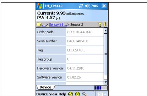
Fig. 24 : Informations sur le capteur avec Field Xpert
