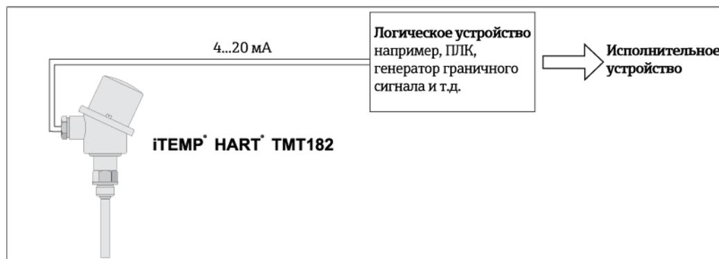
Рис. 2: Реализация функции безопасности (например, при контроле граничных значений температуры) с использованием прибора TMT 182 в качестве подсистемы
