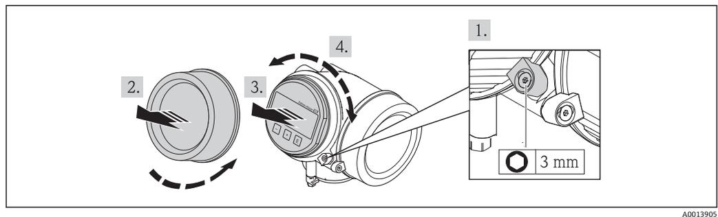
1. 使用内六角扳手松开电子腔盖的固定卡扣。
