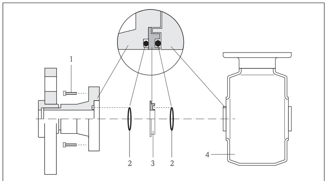
图 7 安装接地环
