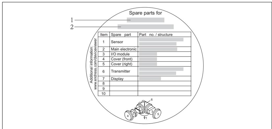
图 27 接线腔盖中的“备件概述图标”示例
