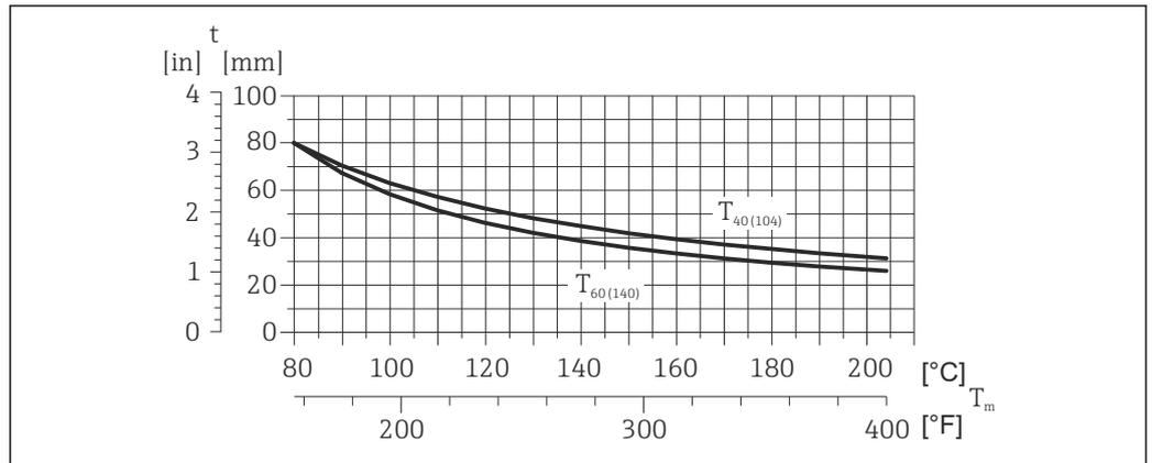
34 Epaisseur d'isolation maximale recommandée en fonction de la température du produit et ambiante
