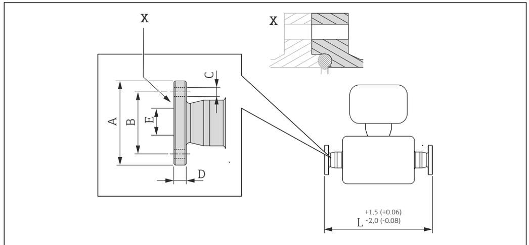
38 Détail X : Raccord process asymétrique, la partie grisée fait partie de la livraison. Unité de mesure mm (in).
