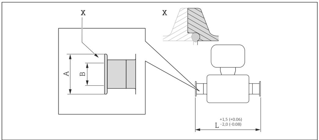
53 Détail X : Raccord process asymétrique, la partie grisée fait partie de la livraison. Unité de mesure mm (in).
