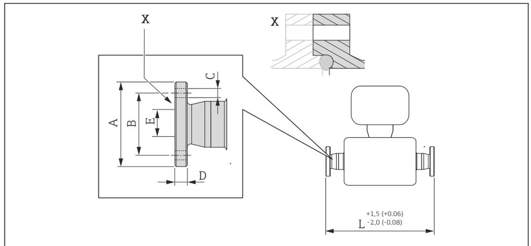
51 Détail X : Raccord process asymétrique, la partie grisée fait partie de la livraison. Unité de mesure mm (in).
