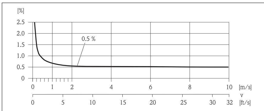
图 29 最大测量误差(% o.r.)示意图
