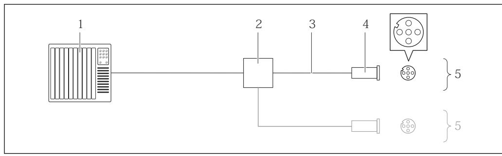
图 16 工业以太网(EtherNet/IP)的连接示例
