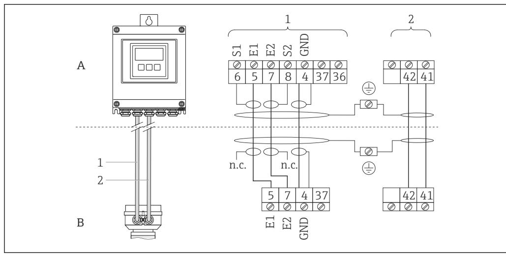
图 10 分体式仪表的接线端子分配示意图
