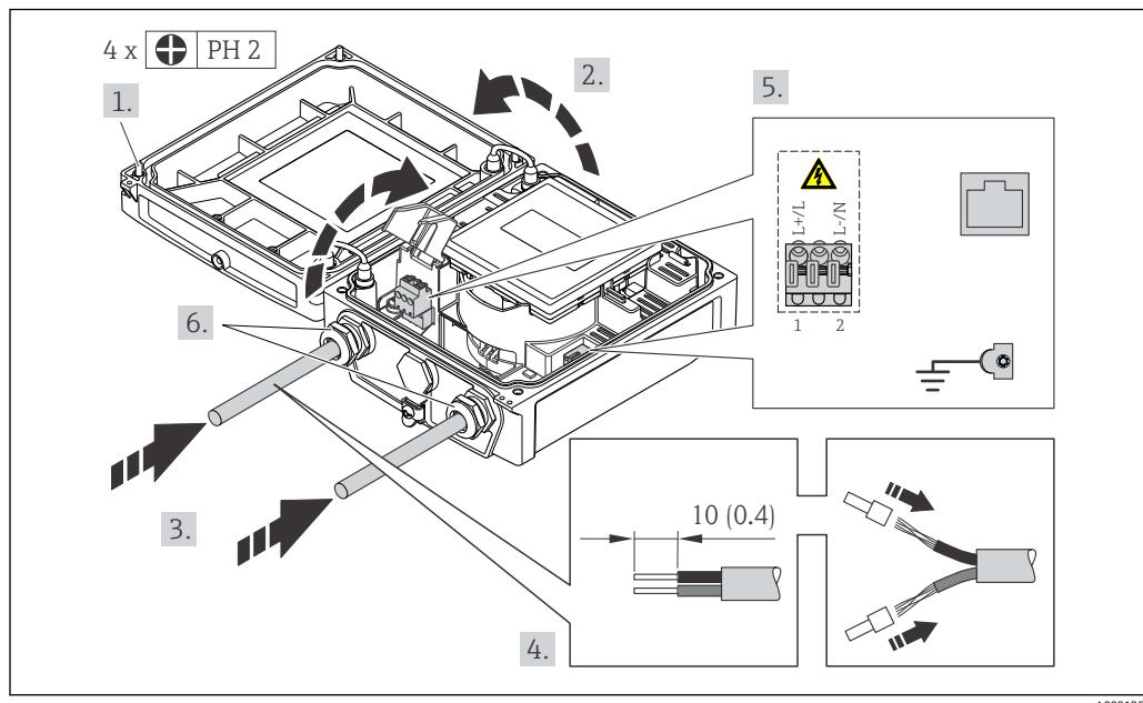
图 13 电源和工业以太网(EtherNet/IP)的连接示意图
