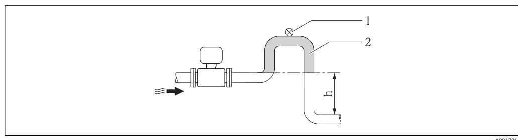
图 4 在竖直向下管道中安装
