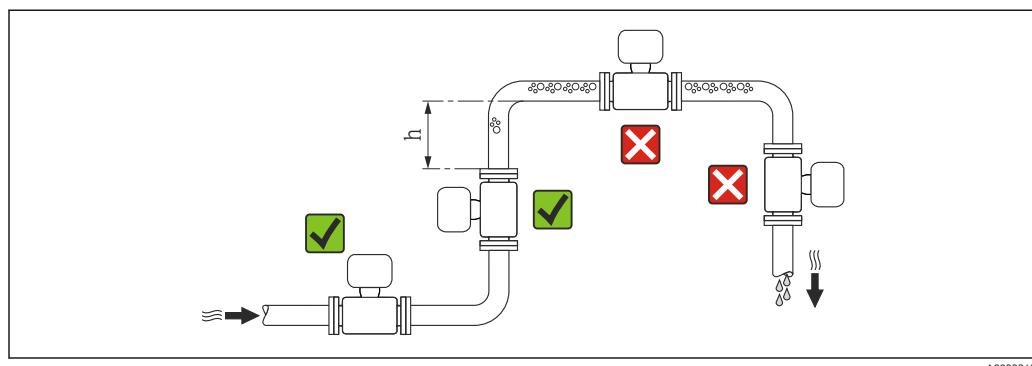
建议将传感器安装在竖直上升的管道中，并确保流量计与下一管道弯头间保留有足够的间距： $h \geq 2 \times DN$ 。
