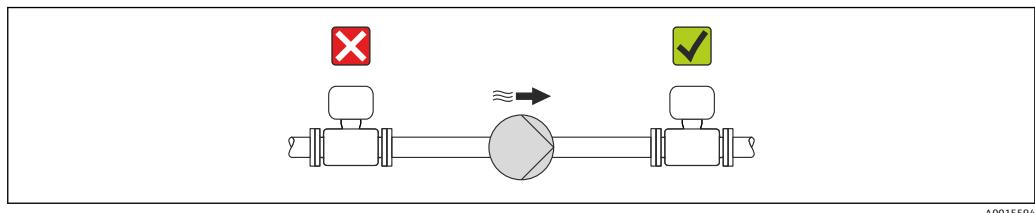
请勿将传感器安装在泵的入口侧，避免抽压时损坏测量管内衬。
