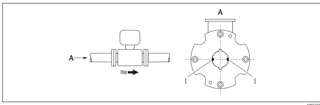
1 测量电极: 信号检测
