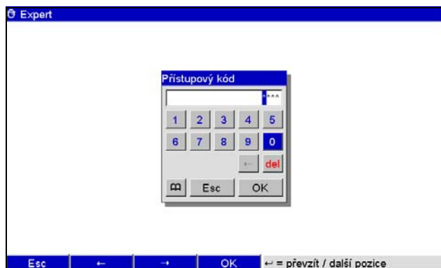
Obr. 23: Přístupový kód v expertním nastavení (nastavení od výrobce: 0000)
